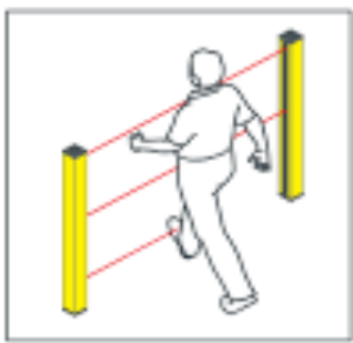
Protezione Corpo risoluzione 300, 400 o 500mm (2, 3 o 4 fasci)
