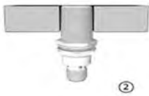
2) Montaggio a filo / sensore schermato
