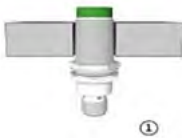
1) Montaggio non a filo / sensore non schermato
